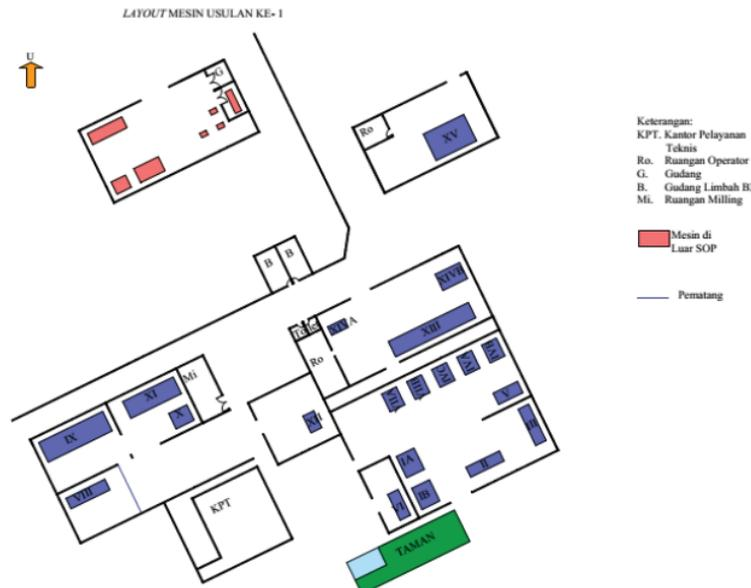
Gambar 3. Layout Mesin Alternatif Usulan Ke-1
